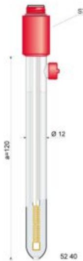
Caratteristiche: Elettrodo di riferimento 5240 per uso generico con riferimento Ag/AgCl incapsulato elettrolita KCl 3M diaframma in ceramica corpo in vetro tappo a vite S7. .
