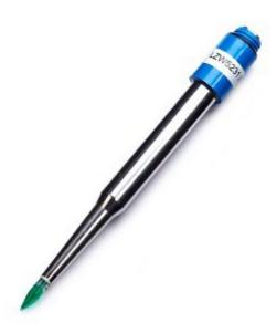
Caratteristiche: Elettrodo combinato a perforazione per pH 5231 con un diaframma in ceramica e uno aperto ed elettrolita solido. Corpo in acciaio inox tappo a vite S7.Questo elettrodo è adatto per campioni alimentari semisolidi, ad esempio formaggio, carne, pesce, frutta, pasta del pane e così via. Il riferimento incapsulato garantisce alta stabilità e lunga durata. Elettrodo a perforazione per campioni alimentari semisolidi. Alta stabilità e lunga durata.
