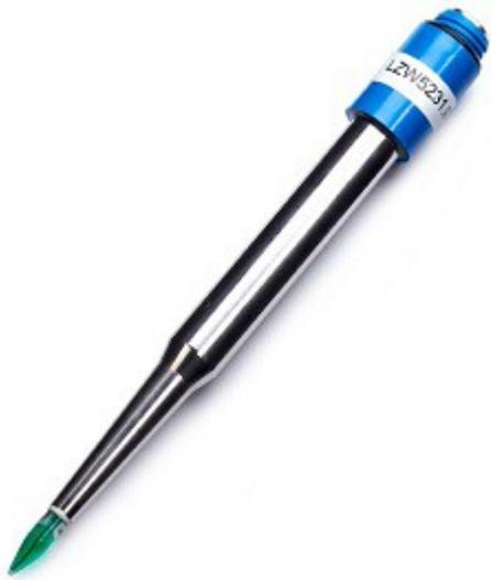
Caratteristiche: Elettrodo combinato a perforazione per pH 5231 con un diaframma in ceramica e uno aperto ed elettrolita solido. Corpo in acciaio inox tappo a vite S7.Questo elettrodo è adatto per campioni alimentari semisolidi, ad esempio formaggio, carne, pesce, frutta, pasta del pane e così via. Il riferimento incapsulato garantisce alta stabilità e lunga durata.Elettrodo a perforazione per campioni alimentari semisolidi.Alta stabilità e lunga durata .
