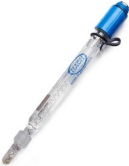
Caratteristiche: Elettrodo combinato di pH, per soluzioni difficili molto alcaline Con diaframma a manica ed elettrolita liquido. Corpo in vetro attacco a vite S7.Questo elettrodo è utilizzabile per soluzioni colloidali, con solidi in sospensione, acque distillate, vini, vernici, emulsioni, creme, campioni con pH alcalino superiore a pH 12, etc.. Il riferimento incapsulato assicura alta stabilità e un tempo di emi vita lungo. .
