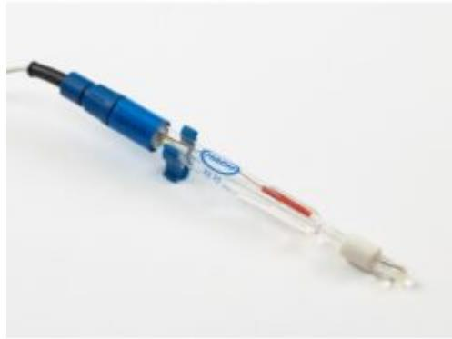
Caratteristiche: Elettrodo combinato per pH 5221 con diaframma sul manicotto ed elettrolita ricaricabile. Corpo in vetro tappo a vite S7. Questo elettrodo è adatto per i campioni più difficili, ad esempio campioni a bassa forza ionica, creme, emulsioni, campioni molto viscosi, vini, vernici e campioni con colloidii. Il riferimento incapsulato garantisce alta stabilità e lunga durata. L'ampia membrana cilindrica per pH fornisce una risposta rapida. Risposta rapida Alta stabilità e lunga durata .
