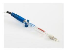
Caratteristiche: Elettrodo combinato per pH 5221 con diaframma sul manicotto ed elettrolita ricaricabile. Corpo in vetro tappo a vite S7.Questo elettrodo è adatto per i campioni più difficili, ad esempio campioni a bassa forza ionica, creme, emulsioni, campioni molto viscosi, vini, vernici e campioni con colloidi. Il riferimento incapsulato garantisce alta stabilità e lunga durata. L'ampia membrana cilindrica per pH fornisce una risposta rapida. Risposta rapida Alta stabilità e lunga durata .
