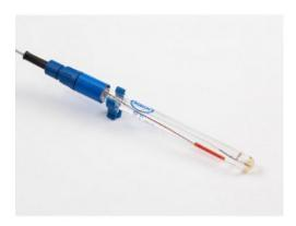
Caratteristiche: elettrodo combinato per pH con 3 diaframmi in ceramica ed elettrolita di rabbocco (KCl glicerina). Corpo in vetro. Tappo a vite S7.Questo elettrodo è adatto per campioni contenenti proteine e per le alte temperature. L'elettrodo è caratterizzato da un'ampia membrana semisferica, un'altissima resistenza e risposta rapida. Robustezza Risposta rapida.
