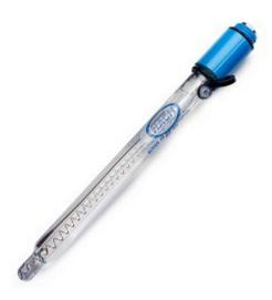
Caratteristiche: Elettrodo di pH combinato con diaframma ceramico a bassa manutenzione corpo in vetro con attacco a vite S7 elettrolita liquidoQuesto elettrodo a bassa manutenzione è utilizzabile su campioni generici acquosi. Un cappuccio protettivo previene ogni rottura ed evita ogni sovrappressione sul diaframma.
