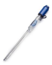
Caratteristiche: Elettrodo pH con liquido (ricaricabile) con diaframma in ceramica. Corpo in vetro Tappo a vite S7 Diametro: 6 mm, profondità minima di immersione: 8 mm.Questo elettrodo per pH è adatto per volumi di microcampioni. Per volumi di microcampioni Elettrodo di riferimento altamente stabile grazie alla cartuccia in buste Sistema di riferimento incapsulato .
