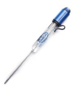
Caratteristiche: Elettrodo pH con liquido (ricaricabile) con diaframma in ceramica. Corpo in vetro. Tappo a vite S7. Diametro: 3 mm, profondità minima di immersione: 5 mm.Questo elettrodo per pH è adatto per volumi di microcampioni. Per volumi di microcampioni. Elettrodo di riferimento altamente stabile grazie alla cartuccia in buste. .
