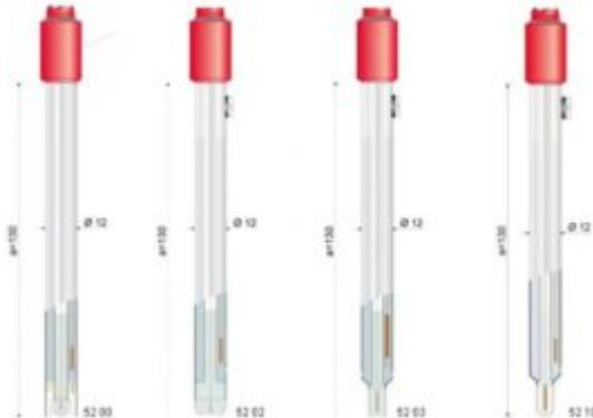
Caratteristiche: Elettrodo di pH combinato al gel con diaframma ceramico per Sension da banco bassa manutenzione Corpo in policarbonato con attacco S7 a vite.Questo elettrodo a bassa manutenzione è utilizzabile in matrici acquose pulite. Un cappuccio protettivo previene ogni rottura ed evita ogni sovrappressione sul diaframma. .
