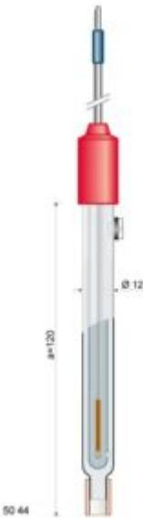
Caratteristiche: Elettrodo di riferimento per applicazioni ISE Ag/AgCl con acetato di litio 0,1 M diaframma in ceramica con cavo da 1 m e connettore a banana. .
