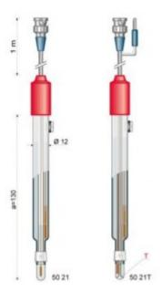
Caratteristiche: Elettrodo per pH con liquido (ricaricabile) con diaframma sul manicotto. Compensazione automatica della temperatura. Corpo in vetro. Cavo da 1 m.Per misuratore da banco.Questo elettrodo è adatto per i campioni più difficili, ad esempio campioni a bassa forza ionica, creme, emulsioni, campioni molto viscosi, vini, vernici e campioni con colloidi. La cartuccia in buste assicura la stabilità dell'elettrodo di riferimento.
