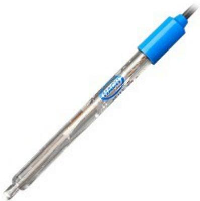
Caratteristiche: Elettrodo per pH con diaframma aperto circolare ed elettrolita solido. Compensazione automatica della temperatura. Corpo in vetro. Cavo da 1 m. Per misuratore da banco. L'elettrodo è adatto per applicazioni con acque reflue, campioni sporchi, terreni viscosi e alimenti. Il diaframma aperto intorno alla membrana favorisce le misure in terreni dove altri elettrodi incontrano difficoltà.
