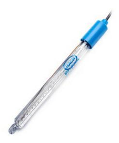
Caratteristiche: Elettrodo combinato per pH con diaframma aperto circolare ed elettrolita solido. Cavo da 1 m. Per misuratore da banco.L'elettrodo è adatto per applicazioni con acque reflue, campioni sporchi, terreni viscosi e alimenti. Il diaframma aperto intorno alla membrana favorisce le misurazioni in terreni dove altri elettrodi incontrano difficoltà.
