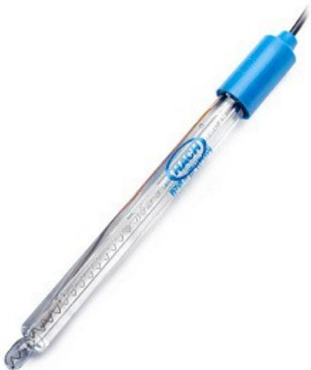
Caratteristiche: Elettrodo combinato per pH con diaframma aperto circolare ed elettrolita solido. Cavo da 1 m. Per misuratore da banco. L'elettrodo è adatto per applicazioni con acque reflue, campioni sporchi, terreni viscosi e alimenti. Il diaframma aperto intorno alla membrana favorisce le misurazioni in terreni dove altri elettrodi incontrano difficoltà. .
