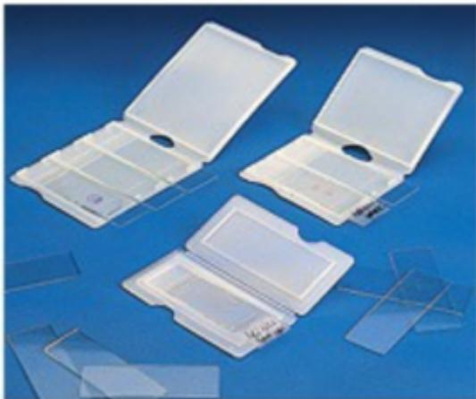
Vetrini portaoggetto per esami di microrganismi viventi come batteri o lieviti. Superficie piana e pulita, bordi molati. Spessore di 1,5 mm, diametro delle celle di 15 mm.
